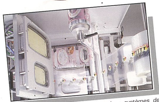
Version "Outillage Mixte" avec deux systèmes de débobinage et rembobinage indépendants pour produire indépendamment sur l'une et/ou l'autre piste.
