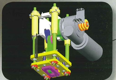
Azionamento stampo chiusura. Mechanical cam operating system - sealing tool closing. Groupe mécanique actionneur de l'outil d'opercelage. Antrieb Verschlusswerkzeug. Accionamiento molde de cerrado.
