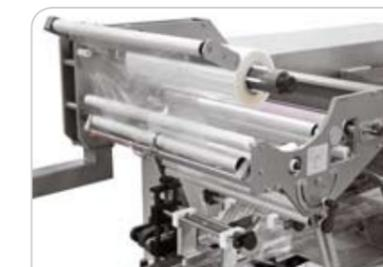
Porte bobine motorisé avec fixation pneumatique
