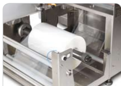
Porte-bobines de chargement frontal qui facilite le chargement de la bobine
