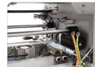
Servomoteur pour le transfert des barquettes dans le moule
