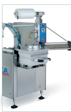
Meilleur accès au poste de soudure : Le dispositif d'entraînement du film supérieur peut pivoter afin de laisser l'outillage coulisser vers l'avant de la machine pour une manipulation plus aisée.
